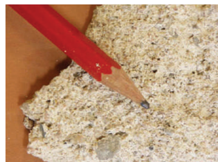
Mortier d'enduit de la fin du 18ème: les grains sont très variés (jusqu'à 10mm)
